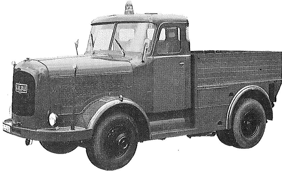
**Diesel-Motor · 6 Zylinder · 4-Takt · 280 PS, bei 2100 U/min**
